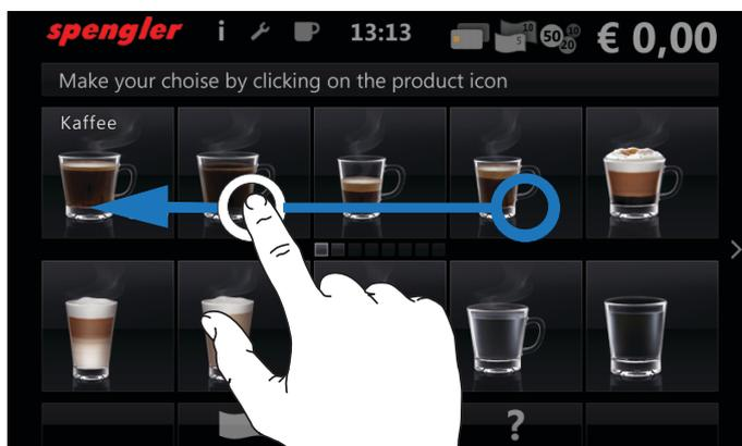
Getränkeauswahlstasten (durch Berühren eines Produktbildes wird das Getränk ausgewählt und das Zutatenmenü („Abb. 51: Rezeptureinstellung“ geöffnet).
