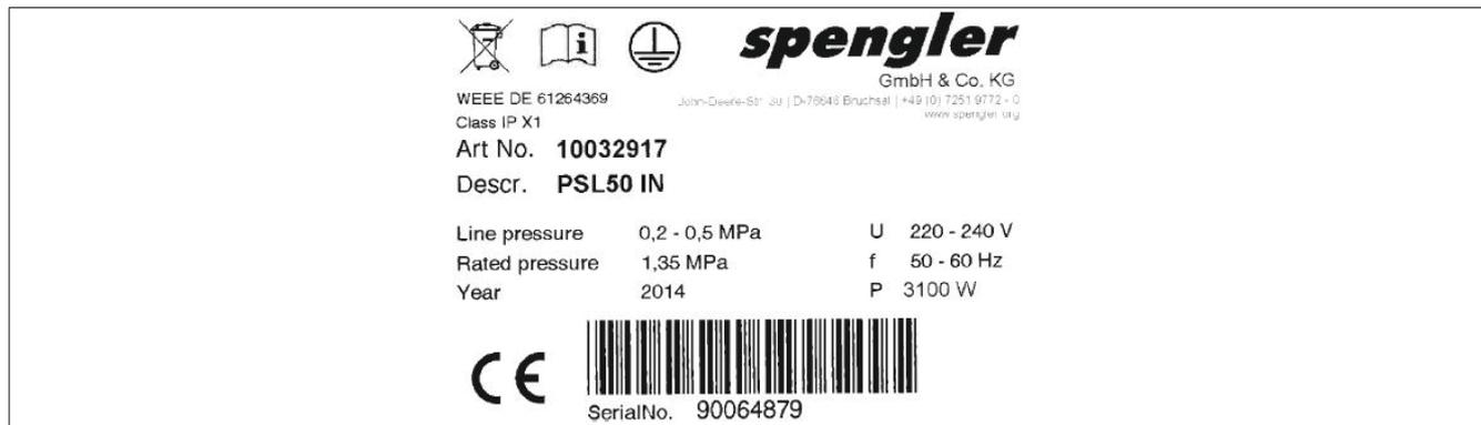
Abb. 1: Beispielhafte Darstellung eines Typenschildes:
