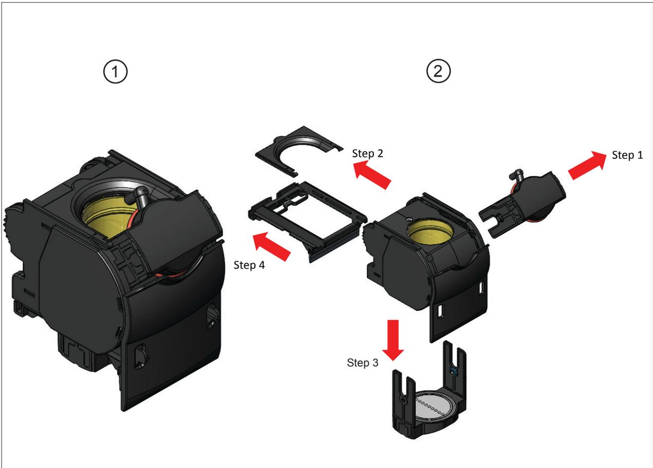
Abb. 119: Monobrüher demontieren
